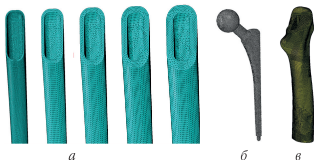
Рис. 3. Конечно-элементные модели: а – цементной мантии толщиной 1-5 мм; б – конической ножки для цементной фиксации; в – бедренной кости
