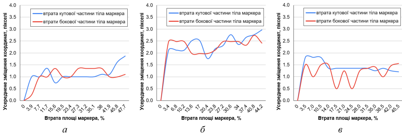
Рис. 3. Усереднене зміщення координат побудованого маркера по відношенню до оригінального: а – для маркерів DICT_4X4 із розміром 3x3 см; б – для маркерів DICT_4X4 із розміром 5x5 см; в – для маркерів DICT_7X7 із розміром 5x5 см.
