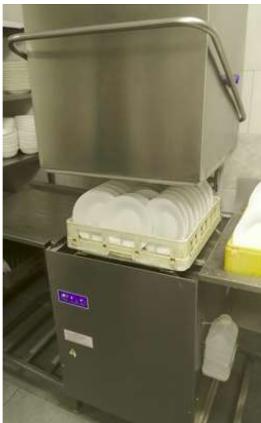
Рис. 2.3. Посудомийна машина купольного типу з регульованим термостатом та касетами для миття
