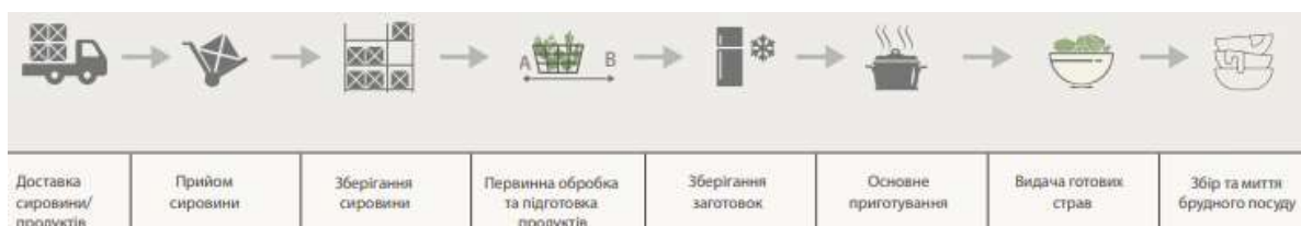
Рис. 2.2. Схема поточності технологічного процесу для технологічної моделі харчового блоку «базова кухня»
