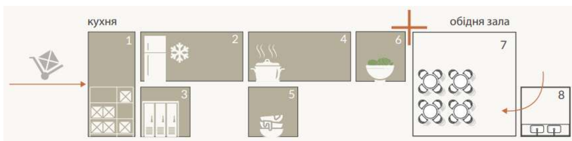
Рис. 2.1. Схема зонування харчового блоку за моделлю «базова кухня»
